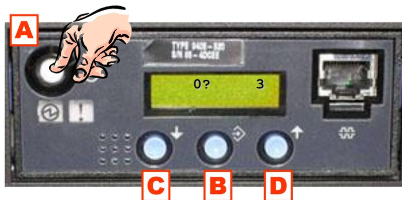
Quando ricompare sul pannello 01 B M oppure 01 B N e la luce del power lampeggia l'IBM i è spento
